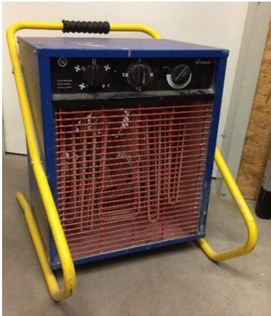
Portabler Heizlüfter zur Trocknung nasser/feuchter Räume oder zeitweise bzw. dauerhafte Beheizung von Räumen.
