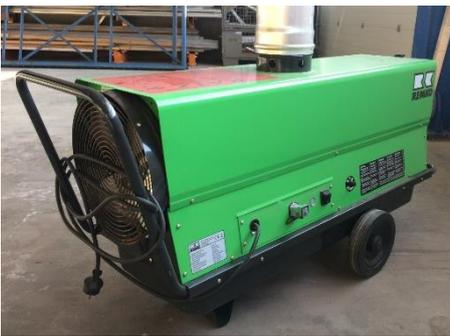
Mobile Zeltheizung zur Beheizung von größeren Räumen bzw. Zelten. Die Abgase werden separat abgeführt, der zu beheizende Raum wird dadurch mit sauberer Warmluft versorgt. Der Anschluss von Warmluftschläuchen ist möglich, zur optimalen Luftverteilung.
